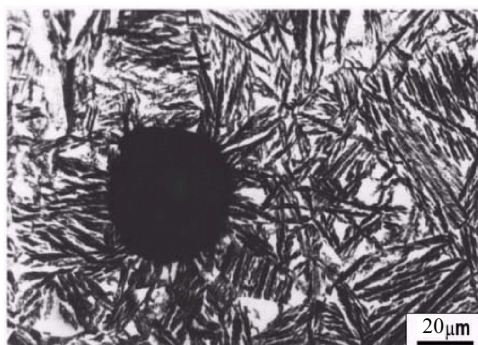
شکل 11. ریزساختار چدن داکتیل آستمپر شده دما 375^{\circ}\text{C} و 150 دقیقه
