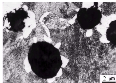
شکل 1. ریزساختار چدن داکتیل ریختگی
